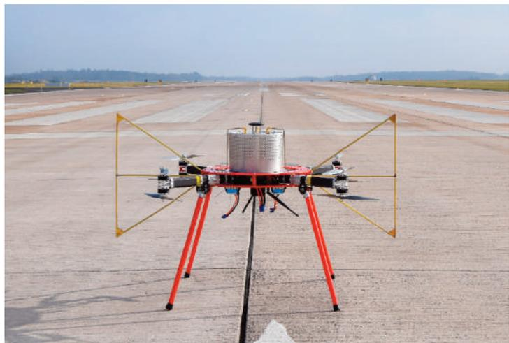
Las capacidades del receptor ligero son numerosas: mediciones de localizador (LOC) y senda de planeo (Glide Path o GP); filtro de la DDM (diferencia de profundidad de modulación) y de los datos de rumbo de acuerdo con el documento 8071 del Anexo 10 de la OACI; análisis por separado de estos datos y autorización con una sola medición; así como avanzados filtros paso banda para eliminar los componentes espectrales no deseados.
