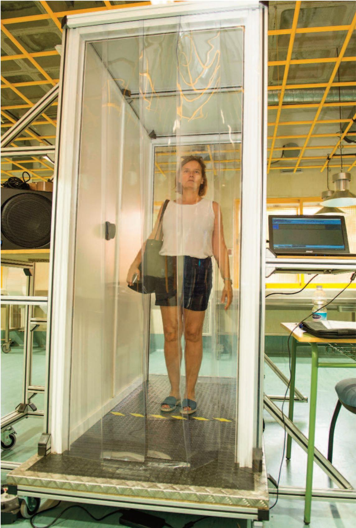
rise es una tecnología que sustituiría al actual cacheo, y cuya función es detectar los objetos adheridos al cuerpo del pasajero. Para ello, el sistema se basa en la dispersión de ondas mecánicas y en infrasonidos totalmente inofensivos que permiten llevar a cabo un registro sin contacto, algo que nunca se había logrado hasta ahora, y que supone tanto un aumento en la seguridad del personal del aeropuerto como un mayor respeto por la intimidad del usuario.
